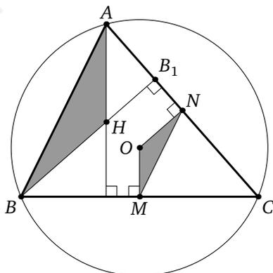
Значит,  $MN \parallel AB$  и  $MN = \frac{1}{2}AB$ , а т.к.  $OM \perp BC$  и  $AH \perp BC$ , то  $OM \parallel AH$ . Аналогично,  $ON \parallel BH$ . Треугольник  $AHB$  подобен треугольнику  $MON$  по двум углам, причём коэффициент подобия  $\frac{AB}{MN}$  равен 2. Следовательно,  $AH = 2OM$ .
